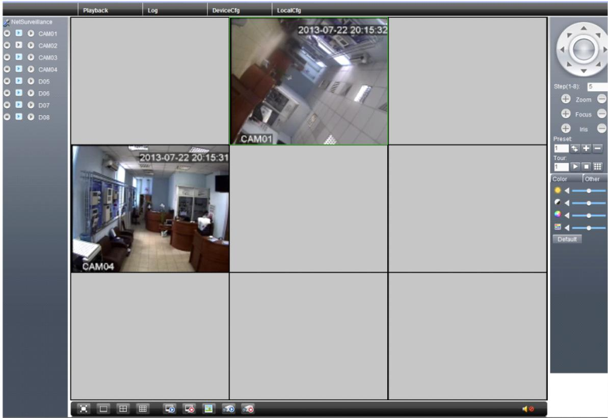
В левой части окна отображается список каналов регистратора. Для каждого канала при активации правой пиктограммы можно осуществлять локальную запись на компьютер. Второй и третьей пиктограммами выбирается основной, либо дополнительный поток с устройства.
